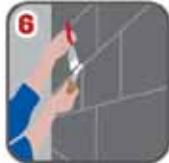
6) Aplique motas de RESISTOL<sup>MR</sup> No Más Clavos<sup>®</sup> con un diámetro de 5 cm y un espesor de 2 cm sobre las marcas previamente hechas.
