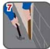
7) Coloque el tablero de yeso marca TABLAROCA<sup>®</sup>, presione con un mazo para distribuir el adhesivo correctamente.
